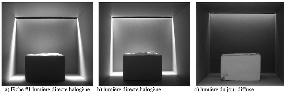
Figure 92 Modification de l'effet d'encadrement lumineux des objets, par modification de la forme lumière projetée
